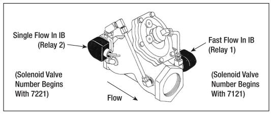
Figure 23. 2-Stage Solenoid Valve
